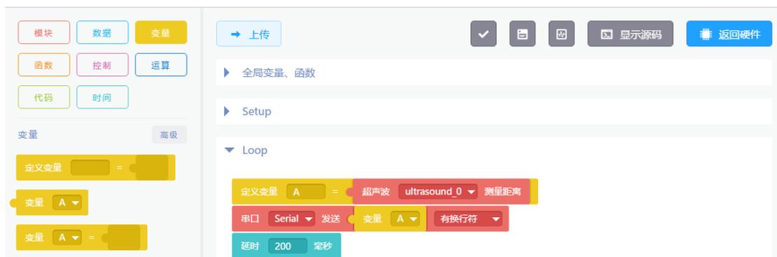
此处读取超声波的数值并赋值给变量 A，再将 A，也就是距离值，从串口发送出来，以便我们从串口监视器查看，这部分知识点可以参考串口相关章节。最后加个延时，防止串口刷新过快。
